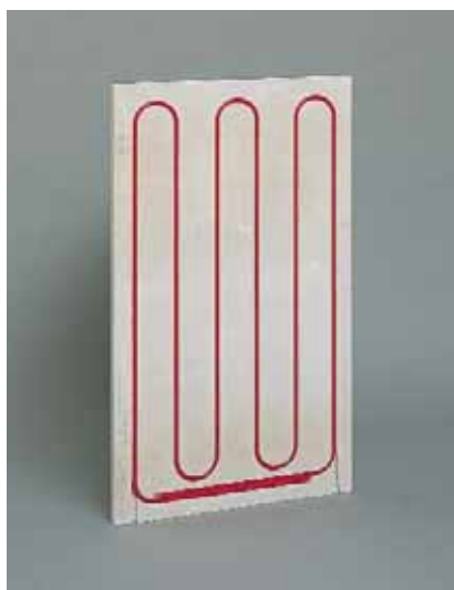
3 Рис. 23: KES- панель большая ШУ104 Длина панели: 100 см Ширина панели: 62 мм Толщина панели: 18 мм Шаг укладки: 104 мм Вес: 12,09 кг Длина уложенной трубы: 6,5 м
